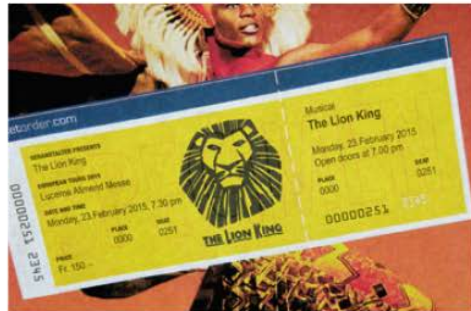
Geïndividualiseerd laserperforeren; van kromme lijnen tot getallen en handtekeningen.
